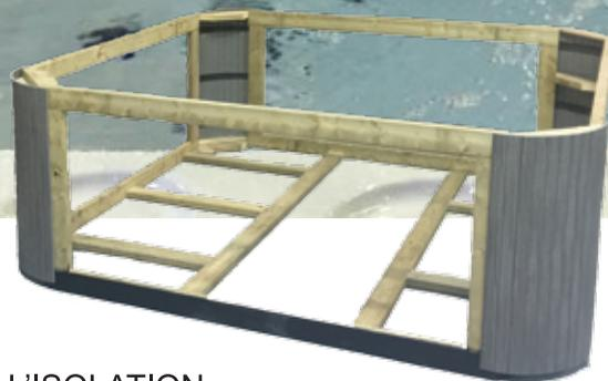
Le châssis est fabriqué en bois autoclave (classe 4) ce qui signifie qu'il est protégé contre les agressions biologiques et résistant aux intempéries et à l'humidité. L'avantage du bois est d'absorber les vibrations, de plus, les pompes sont montées sur silentbloc, pour un spa plus silencieux.
